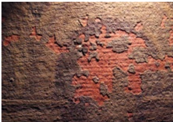
5. Nepoznati slikar, Gospa od Karavaja , kraj 17. stoljeća, detalj oštećenja slikanog sloja pod kosim svjetlom s vidljivim donjim slojem preparacije, Šibenik, katedrala (fototeka HRZ-a, snimila J. Zagora, 2014.)
